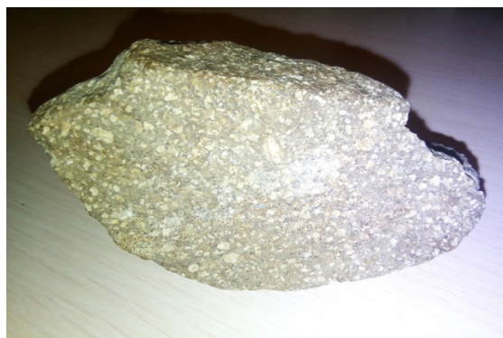
Порфирит — плотная эффузивная порода с вкраплениями тусклых зерен андезина и кварца, редко пироксенов. Отчетливо виден ровный излом и характерное аморфное строение.
