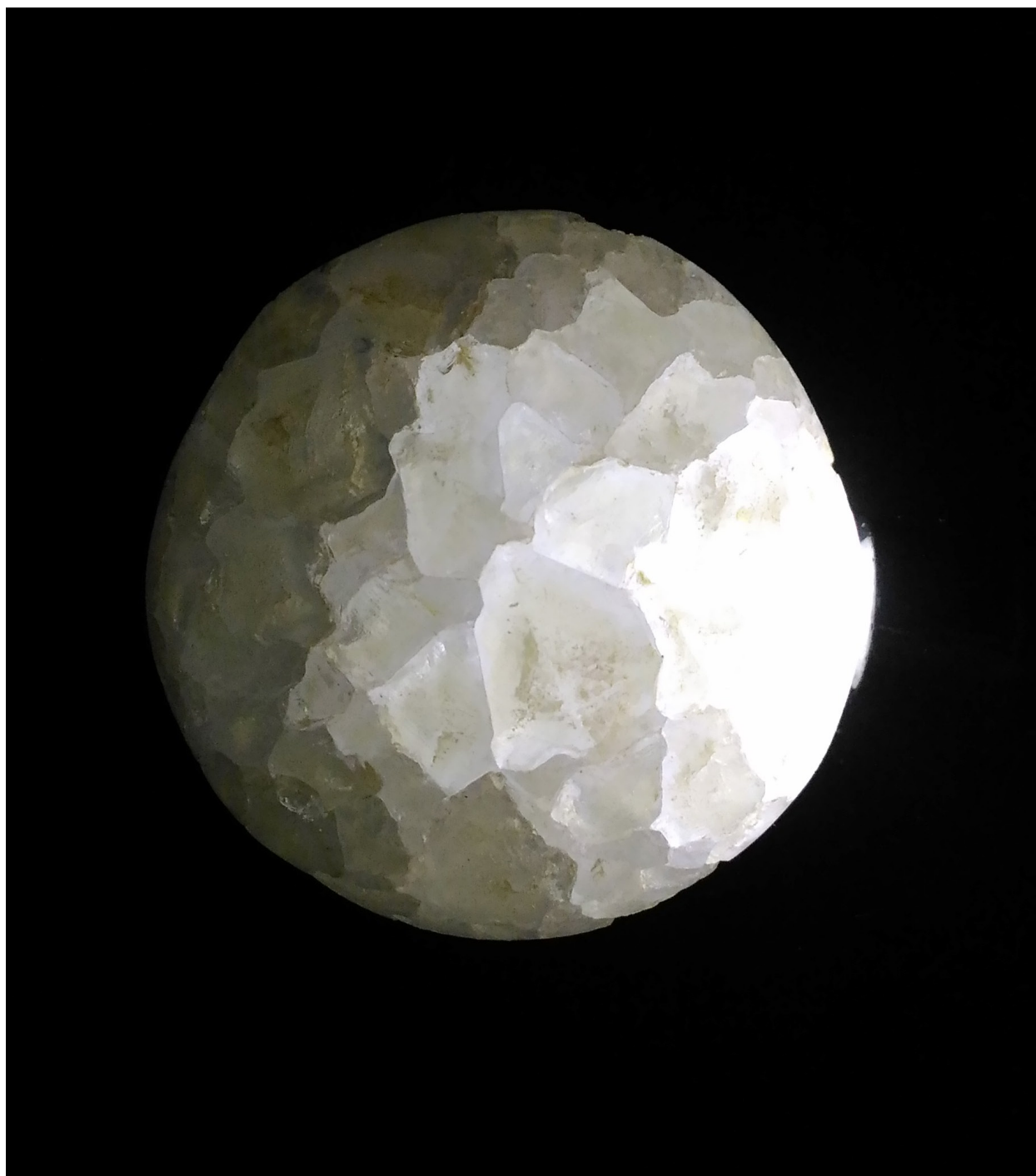
Рис. 7. Образец каменной соли после проведения эксперимента в свете светодиода, спектр которого приближен к спектру дневного света
