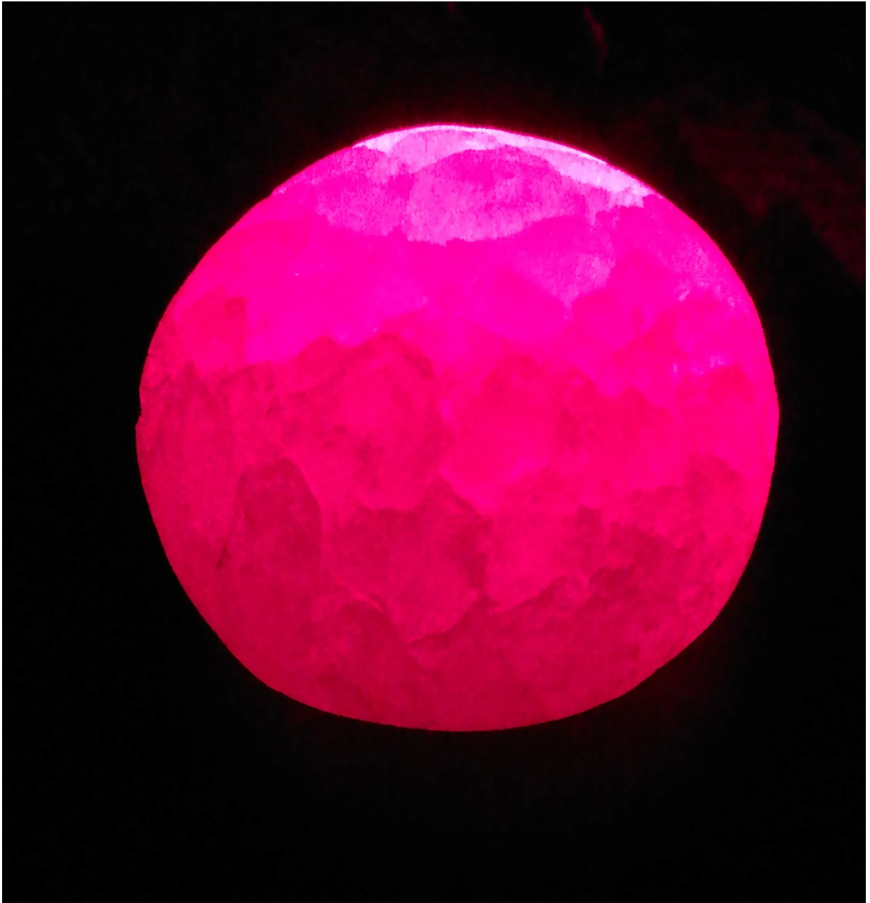
Рис. 6. Образец каменной соли после проведения эксперимента в свете рубинового лазера
