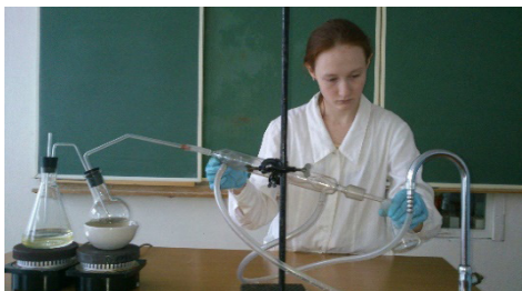
Рис. 5. Выделение эфирных масел методом перегонки с водяным паром
